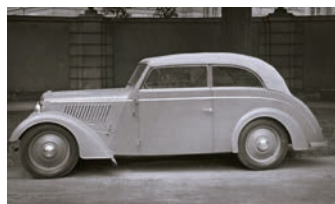
Prototyp der DW-Hellerau für eine DKW F4 Holzkarosse 1934, die nicht in Serie ging Foto: Archiv DW-Hellerau
